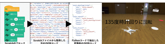
図 2: MR 空間上の仮想ドローンによるプログラミング飛行
