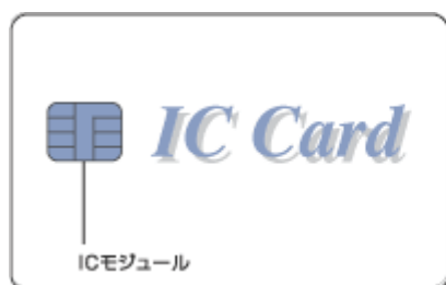
図3 接触型ICカード
